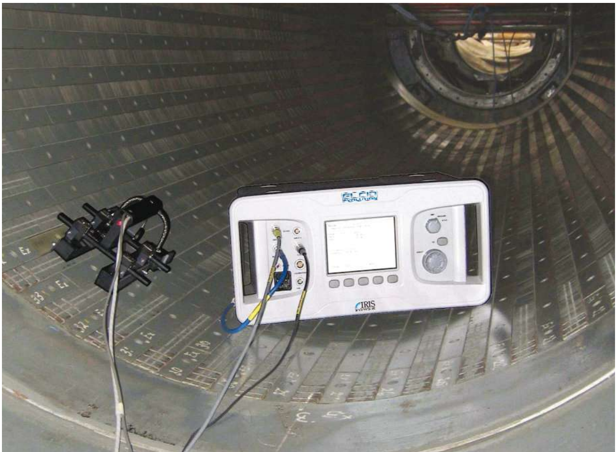
PROBADOR DEL NÚCLEO DEL ESTATOR IRIS POWER EL CID EVOLUTION
